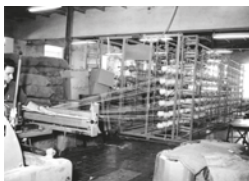
Màquina de Cal Soberano, Autor desconegut, 17/09/1965. Arxiu Històric Municipal, 298. Interior de la fàbrica tèxtil. Detall d'un ordidor i els rodets. L'home que hi apareix és Jaume Joan Guàrdia.
