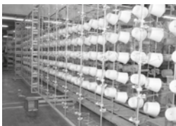
Interior de la fàbrica Cal Soberano, Autor desconegut, 1970-1979. Arxiu Històric Municipal, 10139. Bobines connectades a l'ordidor.
